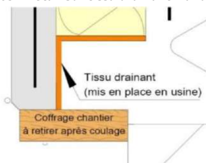
Figure 69 : Détail sur tissu drainant manufacturé
