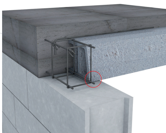
Pour les dalles alvéolées : l'appui minimal sur mur en maçonnerie est de 7,5 cm
