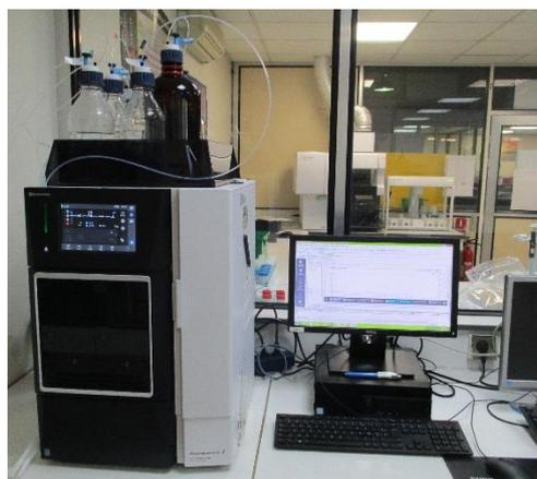
Figure 3 : Photographie du système de chromatographie
