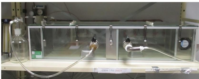
Figure 1 : Chambre d'essai d'émission
