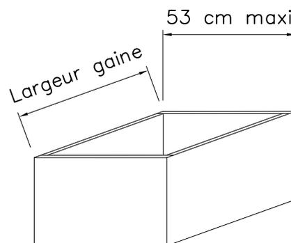
Positionner le coffrage de la réservation en laissant 10 cm minimum entre le polystyrène et le coffrage
