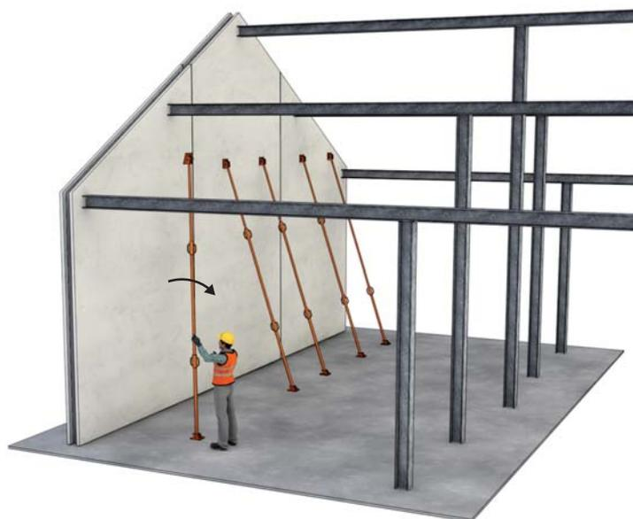
Veiller à s'assurer de la **présence du contreventement définitif** des voiles réalisés en prémur avant enlèvement des étais.
