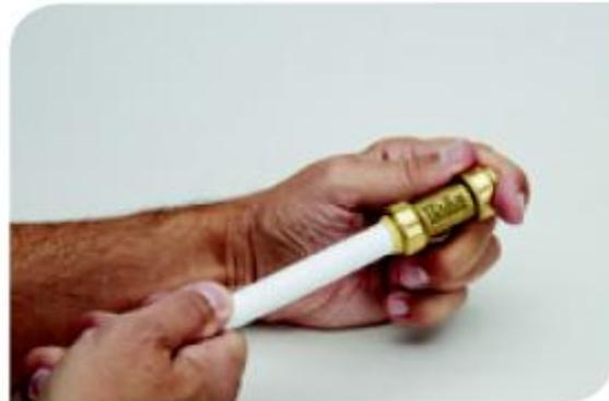
5) Pour le démontage, utiliser la bague de démontage en effectuant une pression sur l'extrémité du raccord et en tirant sur le tube sans forcer, pour le désengager.
