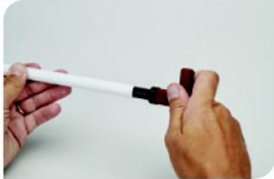
3) Placer l'insert pour multicouche dans le tube
