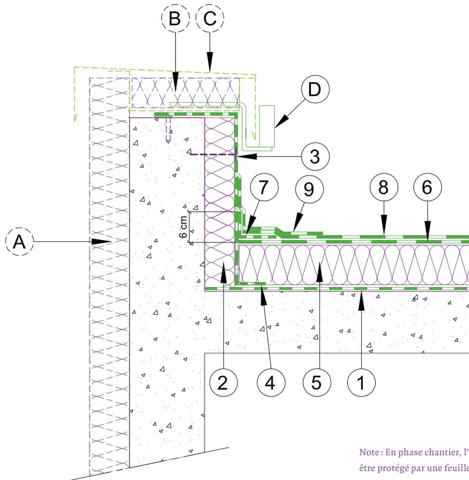
Note : En phase chantier, l'isolant vertical peut être protégé par une feuille bitumineuse.
