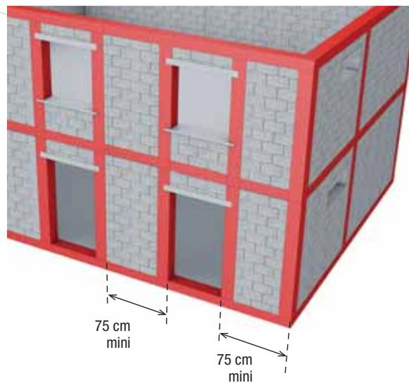
Lorsque la longueur des trumeaux ou des retours d'angles est inférieure à ces limites, les charges à supporter imposent la disposition d'un élément porteur en béton armé conforme au NF DTU 21, en ayant recours éventuellement à des blocs de coffrage.
