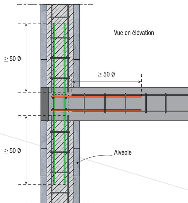
Avant de réaliser la maçonnerie, il convient donc de vérifier, à chaque niveau, que les aciers en attente dépassent suffisamment du niveau inférieur.
