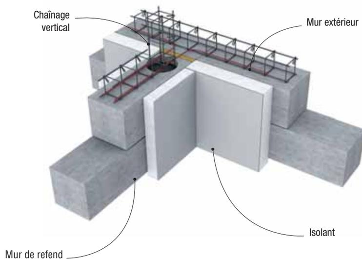
Afin d'améliorer les propriétés acoustiques et coupe-feu (en séparatif logement par exemple), l'isolant intérieur peut être remplacé par de la laine de roche comprimée au montage du refend.
