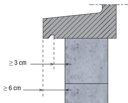
Pour les raccords avec la maçonnerie intérieure, la surface supérieure du rejingot doit régner sur toute la largeur de la baie, y compris dans la feuillure s'il en existe.
