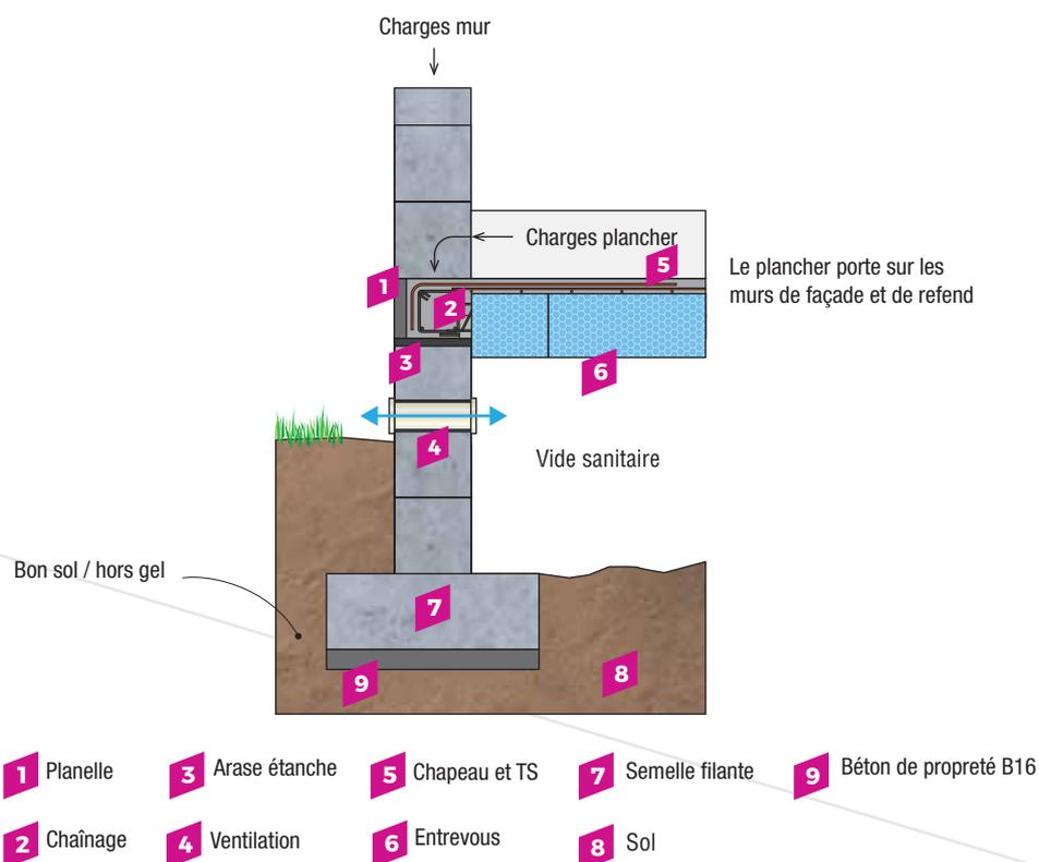
Un vide sanitaire peut être employé sur tous les types de terrains quels que soient leur nature ou leur dénivelé. Il met la construction à l'abri des remontées d'eau et des dégâts dus à l'humidité. Il est réalisé conformément au NF DTU 23.5.
