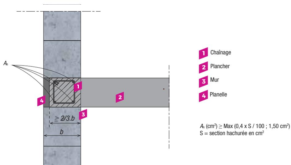
Les chaînages horizontaux sont réalisés de préférence en utilisant des planelles ou des blocs accessoires en U.
