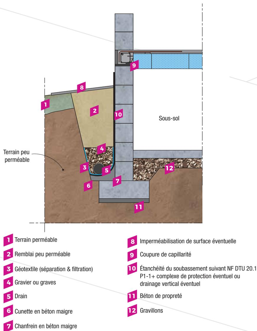
Le drainage périphérique doit toujours se trouver en dessous des dallages intérieurs ; il peut être positionné sur le côté de la semelle ou sur le débord de la semelle avec une cunette.
