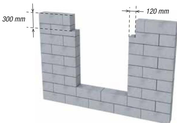
**1** Réalisez des découpes dans le mur correspondant à la hauteur du coffre de volet roulant et permettant un appui de 8 à 15 cm.
