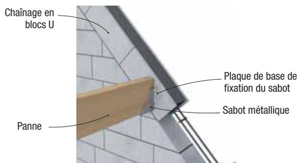
Lorsque les fermes de la charpente s'appuient sur les murs extérieurs, une semelle de répartition des charges concentrées doit être prévue. Elle peut être intégrée au chaînage horizontal.
