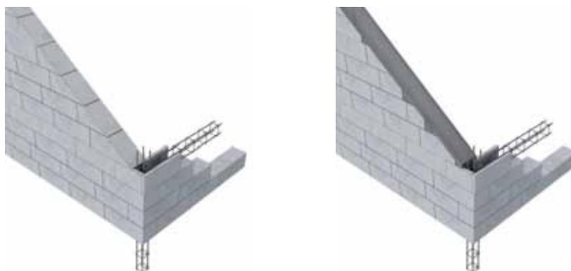
Le rampant est dressé au mortier ou au béton après avoir dépoussiéré les blocs. Les blocs accessoires en U sont posés pour réalisation du chaînage du rampant.
