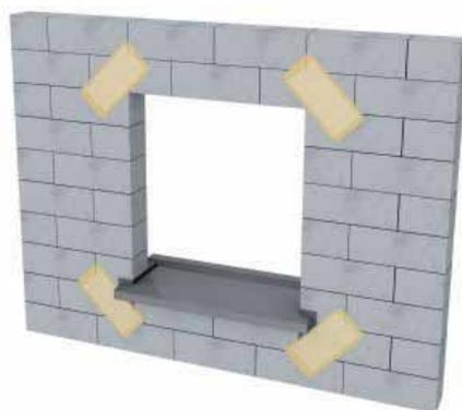
Leurs caractéristiques et leur incorporation par marouflage dans la première couche (ou passe pour l'application d'un enduit monocouche) d'enduit doivent être conformes au NF DTU 26.1.
