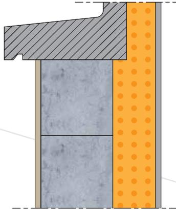
Pour les raccords avec la maçonnerie extérieure, après l'enduisage, en cas d'absence de rejingots latéraux, effectuer un joint au mastic entre l'enduit et la surface de l'appui.
