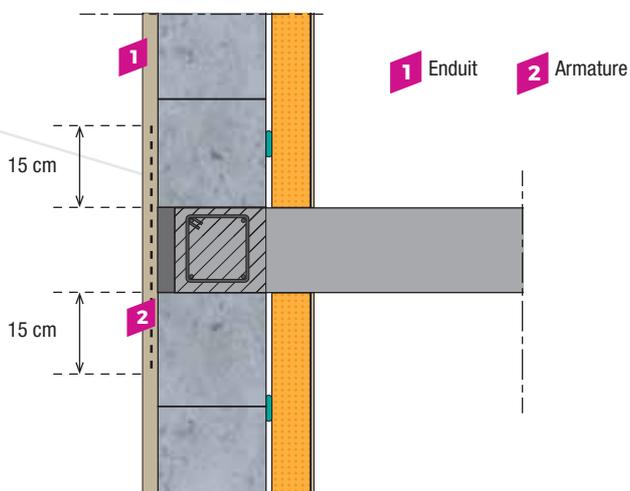
Cette disposition n'est impérative que sur les deux derniers niveaux (y compris le plancher de vide sanitaire ou de sous-sol lorsque l'enduit est filant) dans le cas où un habillage des abouts de planchers (planelle) est prévu.
