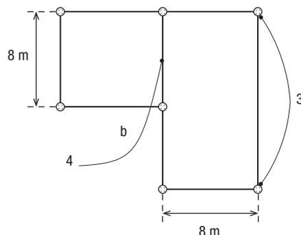
Un chaînage vertical doit être continu entre deux chaînages horizontaux y compris ceux des fondations. Il est ancré dans le chaînage horizontal, dans le chaînage vertical sous-jacent ou dans un élément structurel (poutre, poteau, etc.).
