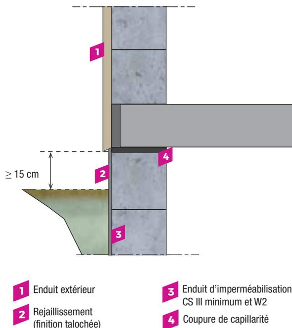
Pour la partie de rejaillissement, les 15 cm minimum au-dessus du sol fini remontant jusqu'à la coupure de capillarité, il est préférable de faire une finition talochée fin pour en faciliter le nettoyage.
