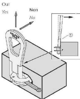
Si l'anneau est en traction vers le centre de la plaque au moment de l'application de la charge, l'étrier risque de se tordre.
