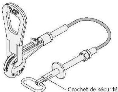
Les anneaux de levage à décrochage à distance soit manuel soit pneumatique sont conçus pour une utilisation avec une distance de sécurité ou lorsque l'endroit de décrochage est difficile d'accès. L'engagement et la manutention de l'anneau se fait comme décrit en page 1. Pour le décrochage manuel à distance : ôter le crochet de sécurité et tirer la poignée. Pour le décrochage pneumatique à distance : le verrou de l'anneau s'ouvre quand la clé est actionnée dans la valve.
