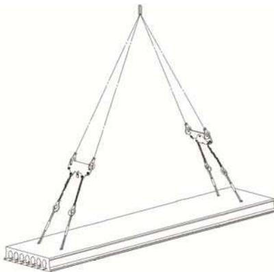
La Capacité maximale utile (CMU) du palonnier devra être supérieure au poids total de la dalle levée majoré des coefficients suivants :
