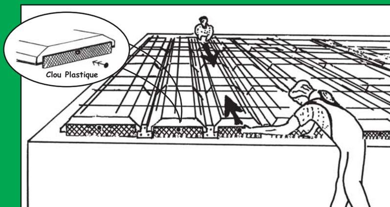
3) Serrer les Seacbois et fixer les tympons au Seacbois de rive après pose des treillis soudés.
