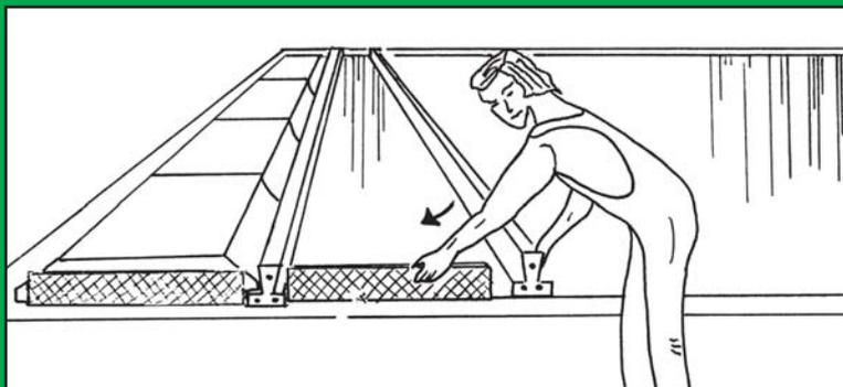
1) Les Tympons servent à régler l'entraxe des poutrelles. Bien les serrer. Pour s'adapter à un biais ou à un point particulier (rives, trémie, entraxe démodulé), le Seacbois peut être redécoupé. Il évite ainsi tout coffrage.
