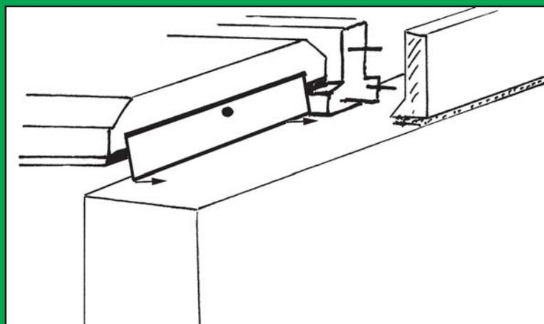
4) Incliner les tympons de 1 cm environ pour une bonne tenue. On peut utiliser des tympons plus longs de hauteur 6,5 cm au maximum.
