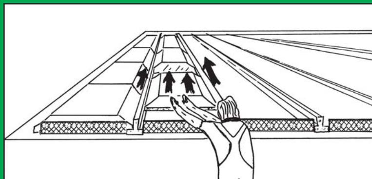
2) Faire glisser les Seacbois sur les talons des poutrelles en restant à l'extérieur du plancher. Pensez à utiliser les chutes pour la travée suivante.
